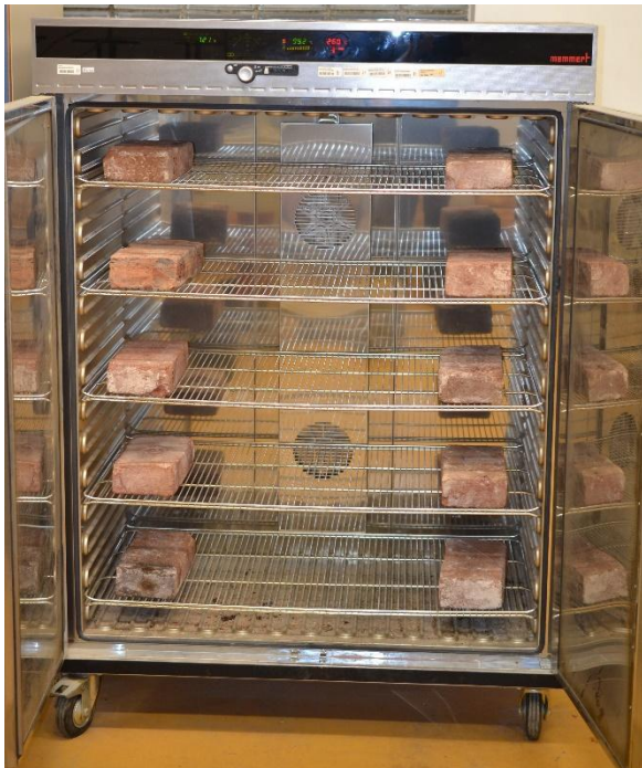
Obr. 11: Vysušení zkušební vzorky do ustálené hmotnosti.
