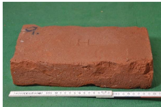
Obr. 51: Zkušební vzorek č.9 po 25 zmraz. cyklech.
