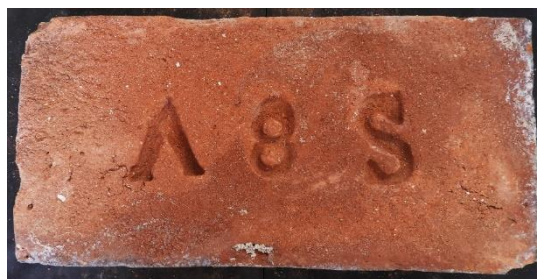
Obr. 10: Jednoduchý negativní kolek vytvořený značkami připevněnými na dno formy, Brno, patrně Adalbert Satzer mezi lety 1860 a 1870.
