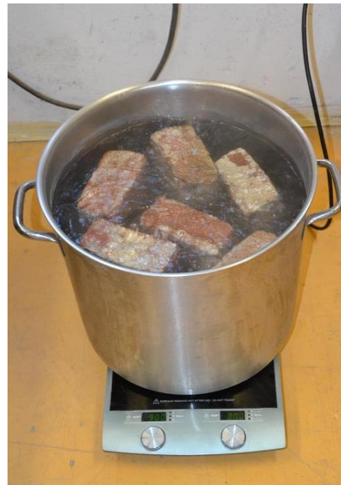
Obr. 14: Sycení vzorků varem dle ČSN EN 772-7.
