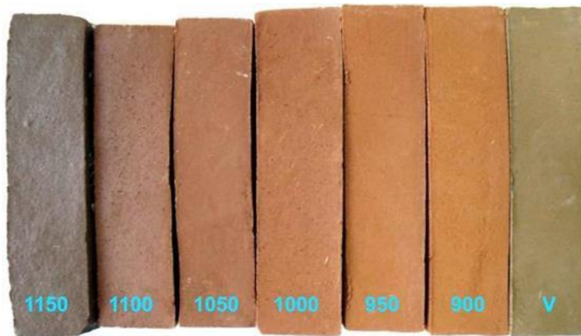
Obr. 1: Barva střepu dle teploty výpalu (V – výsušek).
