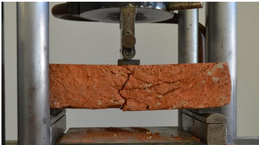
Obr. 17: Zkouška pevnosti v tahu za ohybu cihel o rozměrech přibližně 290×140×65 mm.
