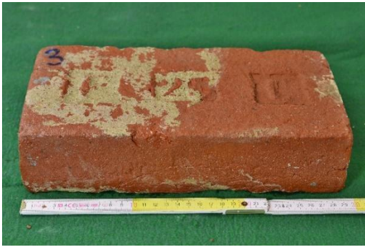
Obr. 38: Zkušební vzorek č.3 po 0 zmraz. cyklech.
