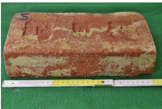
Obr. 42: Zkušební vzorek č.5 po 0 zmraz. cyklech.
