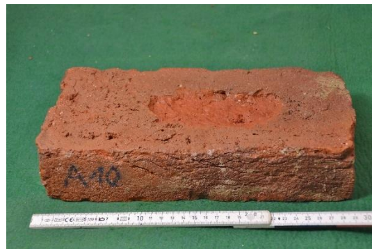
Obr. 53: Zkušební vzorek č. 10 po 25 zmraz. cyklech.
