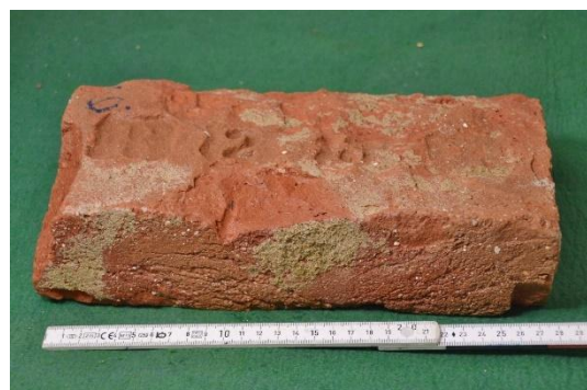
Obr. 45: Zkušební vzorek č.6 po 25 zmraz. cyklech.
