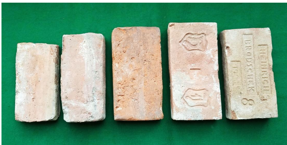
Obr. 7: Názorný příklad porovnání rozměrů cihel v brněnském regionu, zleva 13. st., 15. st., 18. st., cca. 1873, a 1923.
