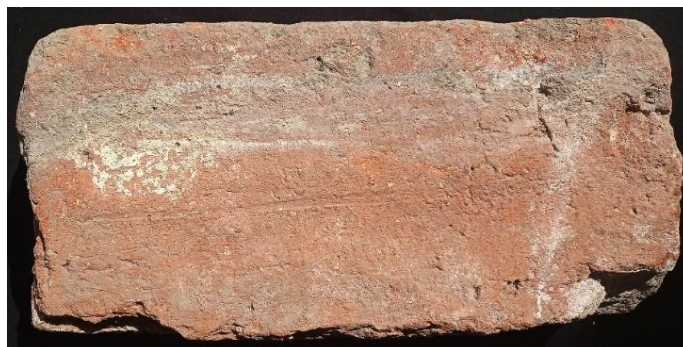
Obr. 3: Lícová strana cihly se stopami seříznutí nástrojem (Rosa Coeli, Dolní Kounice, 15. stol.).
