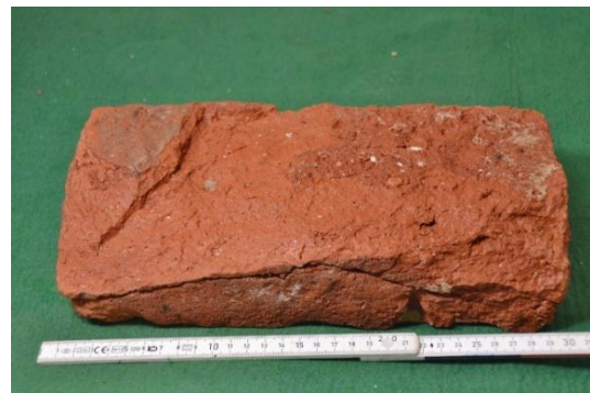
Obr. 37: Zkušební vzorek č.2 po 25 zmraz. cyklech.
