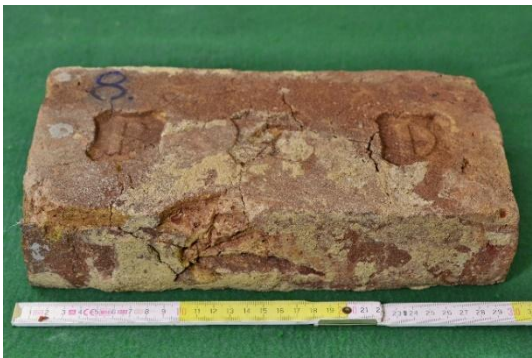
Obr. 48: Zkušební vzorek č.8 po 0 zmraz. cyklech.
