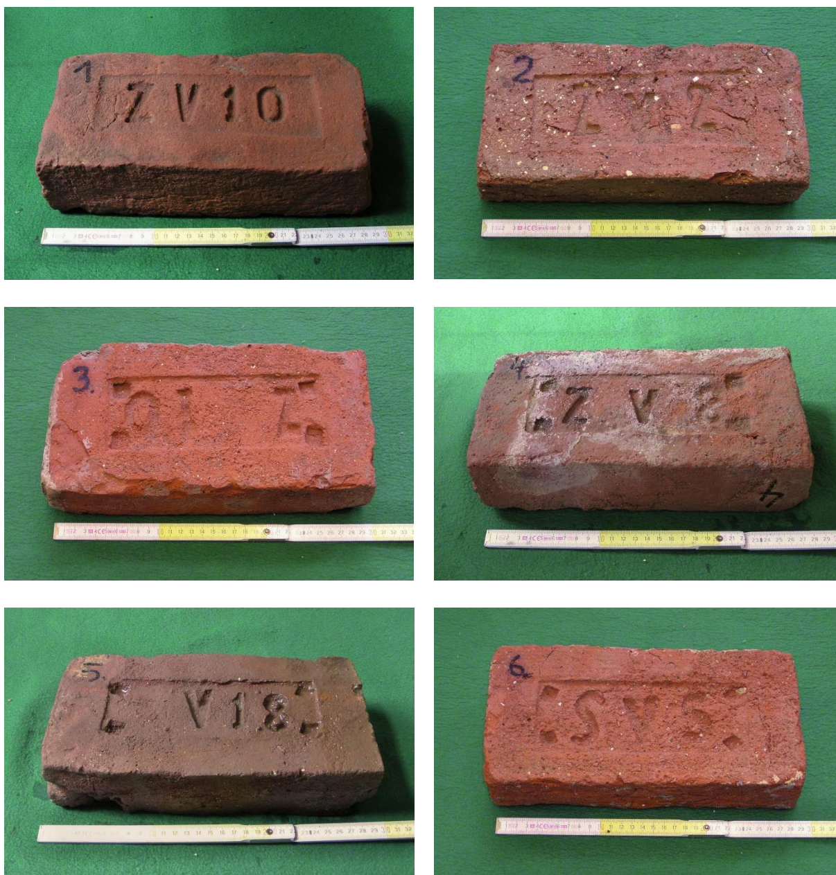
Obr. P1.8: Vzorky historických „náhradních“ cihel č. O 1 až O 6. Vizuálně kvalitnější jsou vzorky O 1, O 4 a O 5, vizuálně nejméně kvalitní je vzorek O 6.
