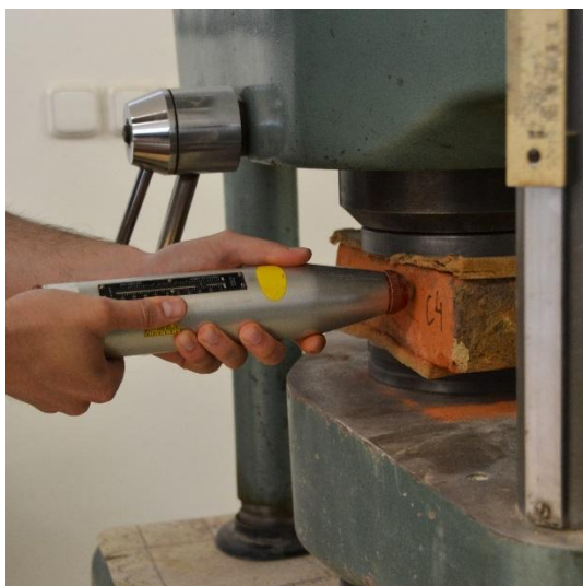
Obr. 21: Zkouška tvrdoměrem Schmidt LB na zatíženém vzorku cihly.
