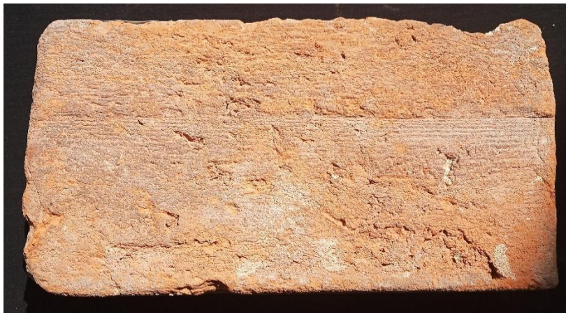
Obr. 5: Stopy po nehoblovaných prknech, barokní cihla, zámek Loučka – otisk dna formy tvořeného ze dvou kusů nebo podklad pod rámovou formou.
