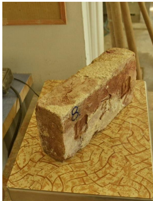
Obr. 12: Stanovení hmotnosti ( m_{dry,u} ) vzorku po vysušení do ustálené hmotnosti.
