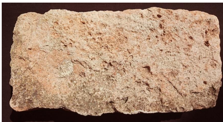
Obr. 4: Stopy podsypu na spodní straně prstované cihly tzv. malého formátu (Brno 13. stol.).
