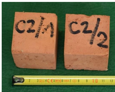
Obr. 19: Reprezentativní zkušební tělesa tvaru krychle o hraně 50 mm.
