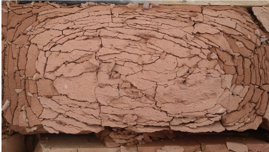
Obr. 16: Detail destrukce vzorku cihly po zmrazovacích cyklech – typický projev tzv. textury.
