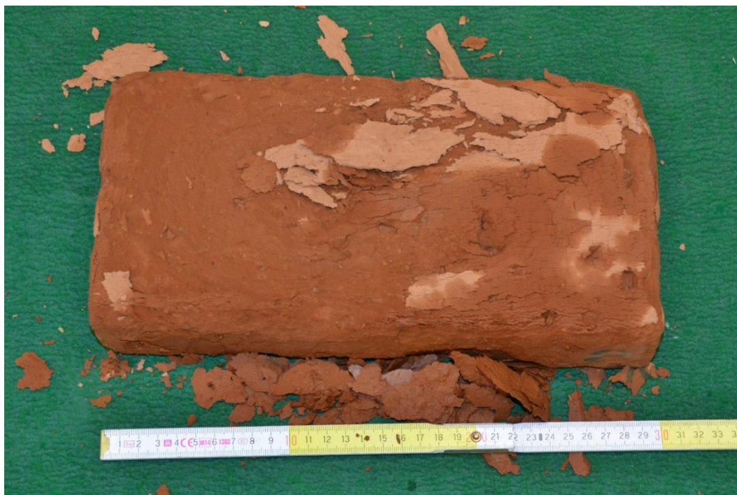
Obr. P1.16: Vzorek č. 2 po 25 zmrazovacích cyklech – došlo k odpadnutí povrchové vrstvy ze všech stěn, navíc je zde patrná výrazná textura.
