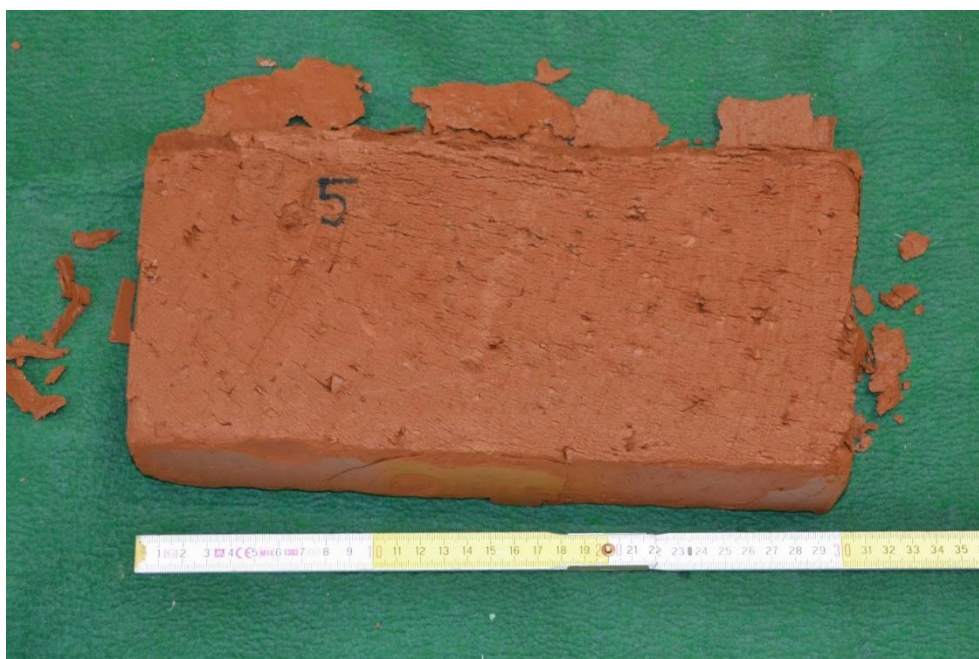
Obr. P1.18: Vzorek 5 po 25 zmrazovacích cyklech – došlo k odpadnutí povrchové vrstvy zejména u bočních stěn.
