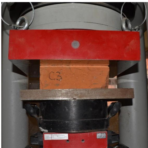
Obr. 18: Průběh zkoušky stanovení pevnosti v tlaku.
