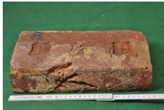
Obr. 49: Zkušební vzorek č.8 po 25 zmraz. cyklech.
