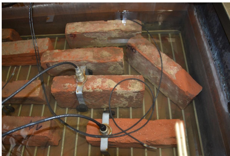
Obr. 15: Zkušební vzorky ve zmrazovacím zařízení před zahájením zmrazovacích cyklů.
