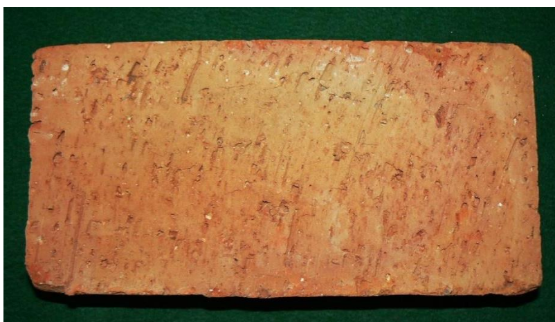
Obr. 6: Znamky řezání cihly z nekonečného pásu vytlačného šnekovým lisem – moderní výroba.
