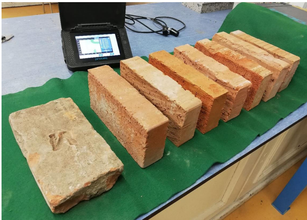
Obr. 95: Vzorky cihel pro stanovení vnitřních vad pomocí ultrazvuku. Vzorky nových cihel A-G pocházejí z různých cihelen, historická cihla N pochází z mostu Portz Insel u Mikulova.
