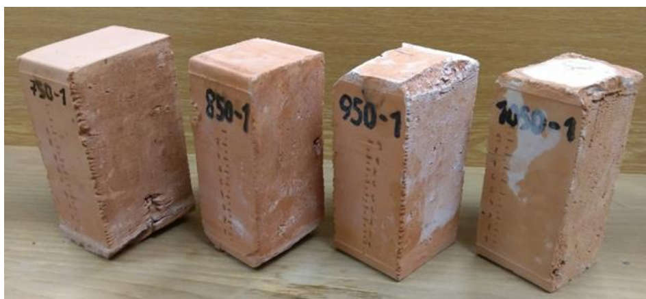
Obr. 27: Vzorky cihel po zkoušce na výkvětovost podle ČSN 72 2608, metoda B.
