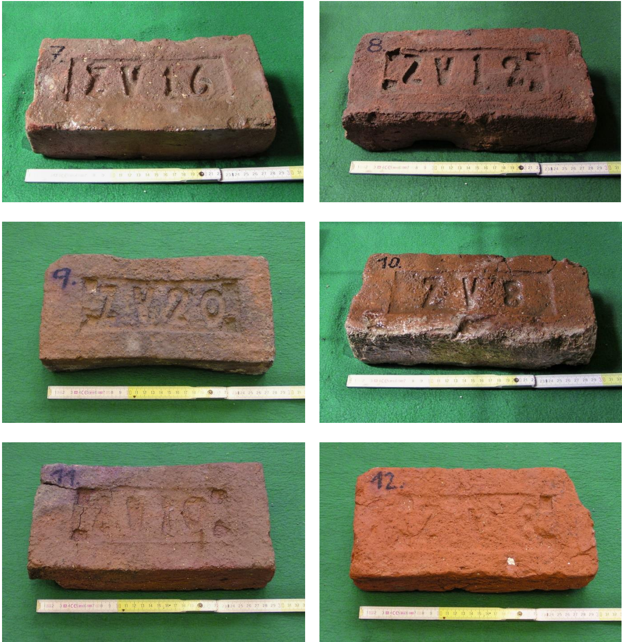
Obr. P1.9: Vzorky starých „náhradních“ cihel č. O 7 až O 12. Vizually nejmeně kvalitní cihly O 10 a O 12, naopak přepálené a prohnuté cihly O 7, O 9 a O 11 (ta ovšem s trhlinami).
