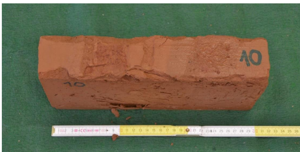
Obr. P1.19: U vzorku 10 je po 25 zmrazovacích cyklech patrné počínající narušení povrchových vrstev, tomu odpovídá i menší pokles měřených veličin.
