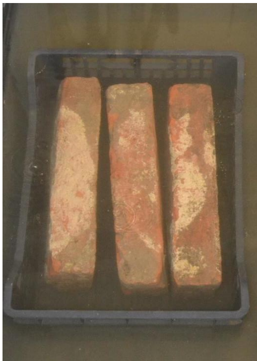
Obr. 13: Sycení vzorků dle metody uvedené v ČSN EN 772-21
