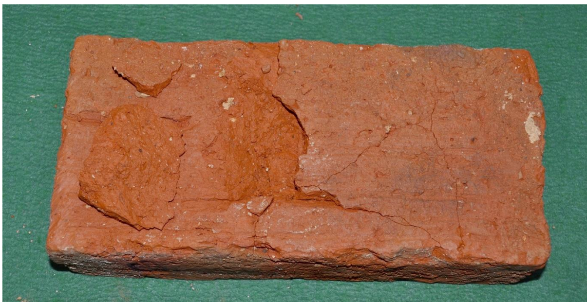
Obr. P1.10: U vzorku O 6 došlo po 25 zmrazovacích cyklech k jeho výraznému porušení trhlinami.
