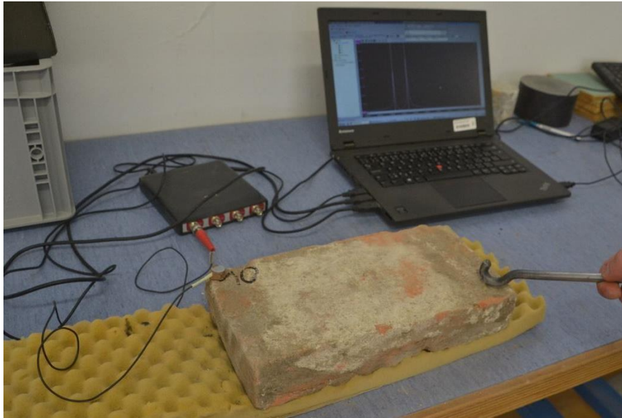
Obr. 23: Stanovení první vlastní frekvence krouživého kmitání zkušební vzorku.
