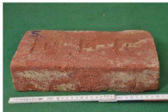
Obr. 43: Zkušební vzorek č.5 po 25 zmraz. cyklech.
