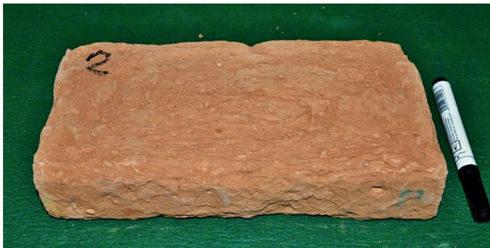
Obr. P1.17: Vzorek 2 po 25 zmrazovacích cyklech, po vysušení a odstranění nesoudržných částí. Je zřejmé, že zatímco povrchová vrstva prakticky ze všech stran opadala, jádro zůstalo celistvé.
